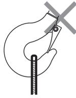
Posição imprópria para fixação da carga elevada ou da eslinga
