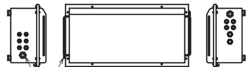
Posição de conexão do cabo da botoeira
